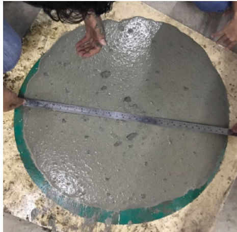
Figura 1- Espalhamento do concreto de Traço 1:3 sem adição mineral.
