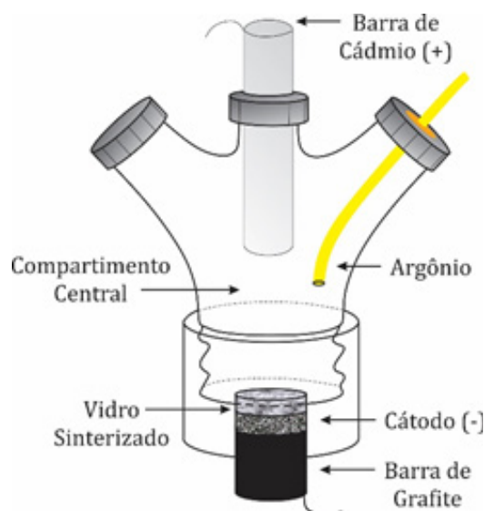
Figura 1: Cella de cavidade utilizada no processo de síntese de QDs.
